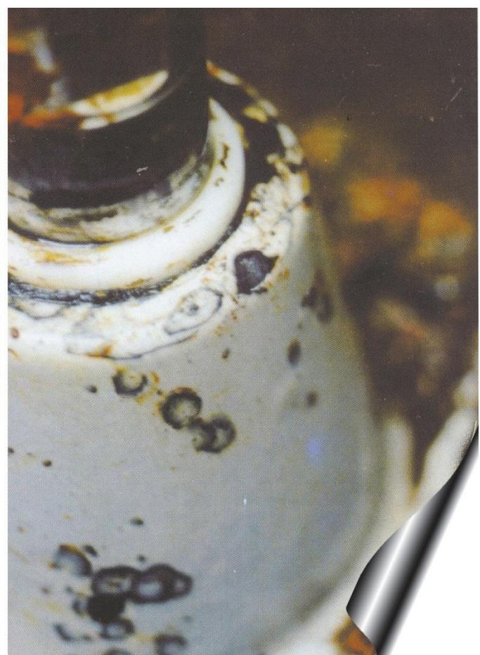
Schieber nach 15-jährigem Einsatz in einem Boden der höchsten Säureklasse. Bild rechts (nach der Reinigung) zeigt deutlich, dass trotz Beschädigung das Unterrosten und Weiterrosten durch die Verbundschicht verhindert ist.
